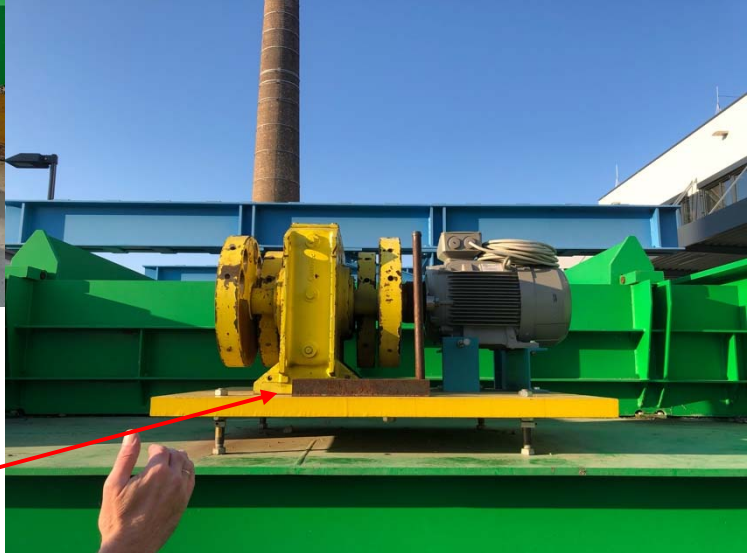
Richterregger, der im Versuch die Schwingung der Brücke erzeugt.
